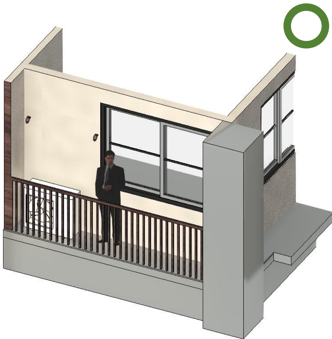
圖 2-2、露樑設置室外機範例
