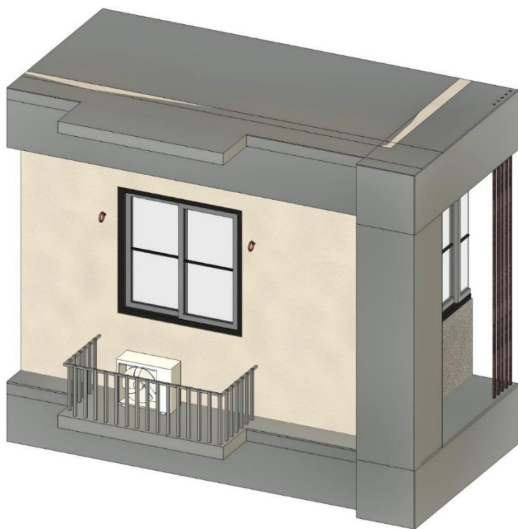
圖 2-1、雨遮設置室外機範例
